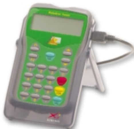
De retour au cabinet, le Baladeur Santé s'installe commodément sur son socle et se connecte à l'ordinateur au moyen d'un câble unique qui permet simultanément l'alimentation du lecteur et sa communication avec le PC.
